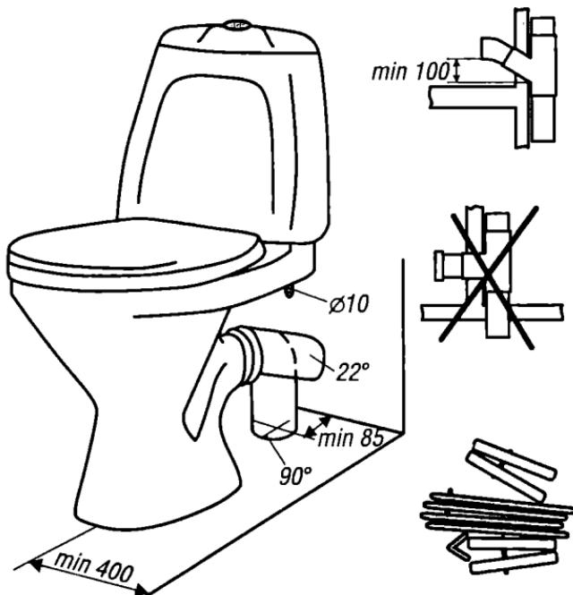
Рис. 12. Базовые размеры для установки унитаза
