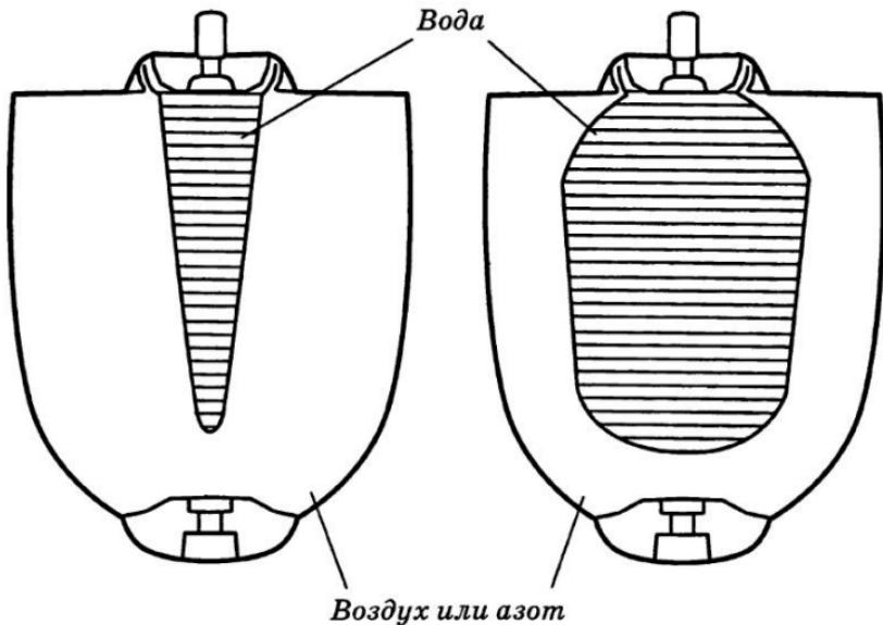
Рис. 45. Расширительный бак
