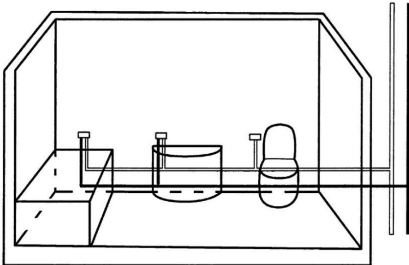
Рис. 16. Тройниковая схема разводки водопровода
