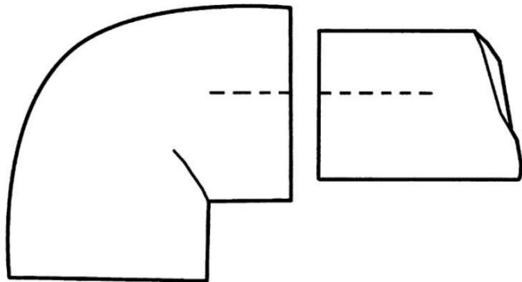
Рис. 18. Разметка соосности
