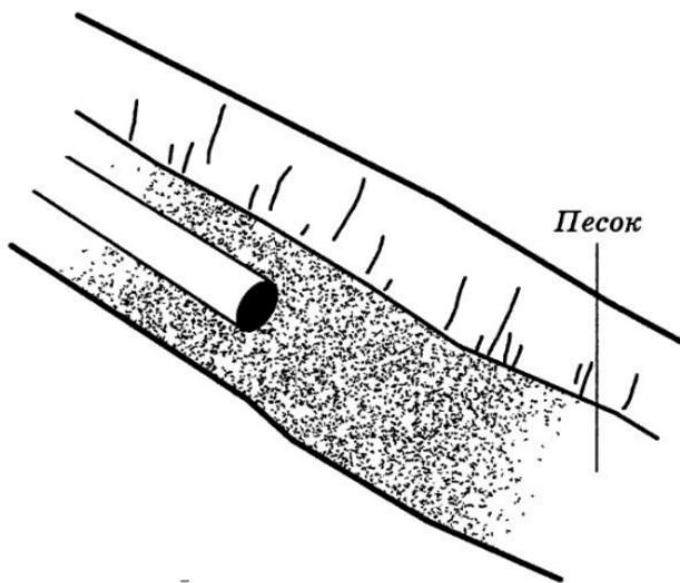
*Рис. 26. Устройство песчаной подушки*
