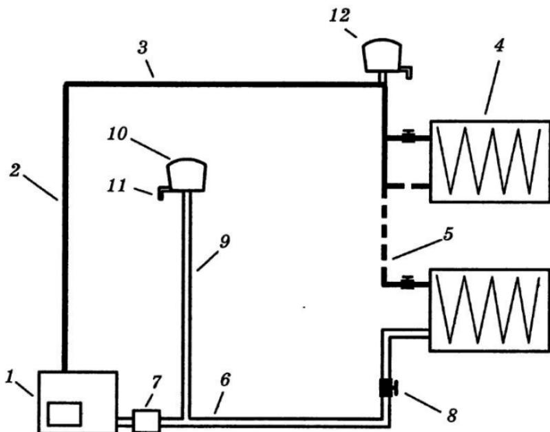
*Рис. 46.* Однотрубная схема с замыкающими участками:
