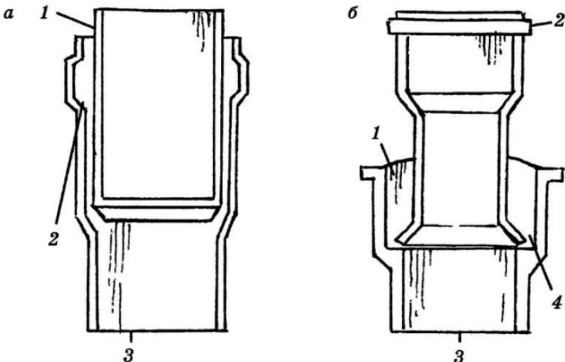
Рис. 36. Способы соединения канализационных труб:
