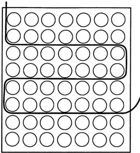
Рис. 66. Прокладка отопительной трубы по профильной теплоизоляции
