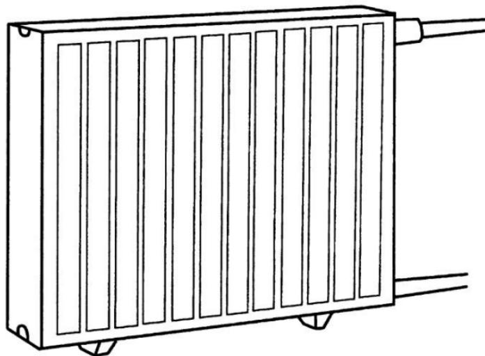
Рис. 51. Стальной панельный радиатор
