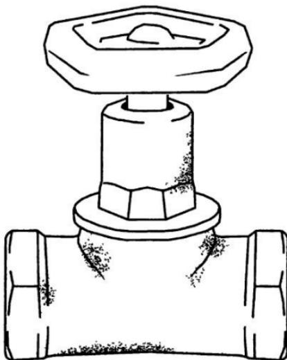
Рис. 14. Запорный клапан (вентиль)
