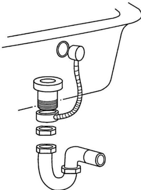
Рис. 93. Схема сборки системы слива — перелива джакузи
