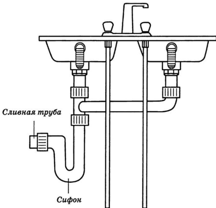
*Рис. 80. Устройство сдвоенной мойки*
