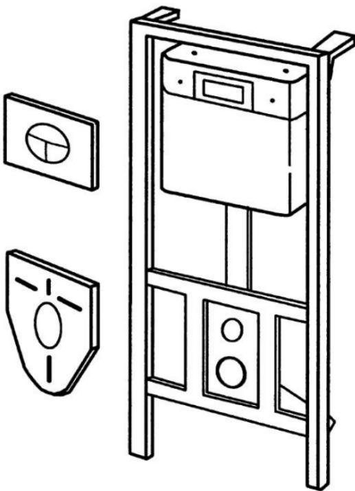
Рис. 84. Устройство встроенного бачка
