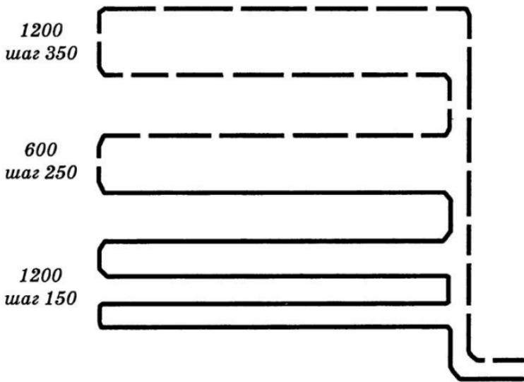
*Рис. 71. Шаг укладки трубопроводов*
