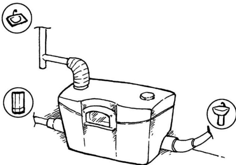
Рис. 38. Компактный резервуар для сбора стоков
