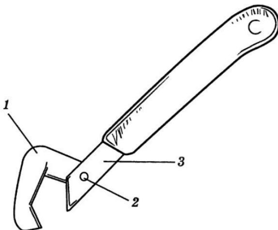
*Рис. 3. Трубный накидной ключ: 1 — накидная скоба; 2 — гайка; 3 — рычаг*
