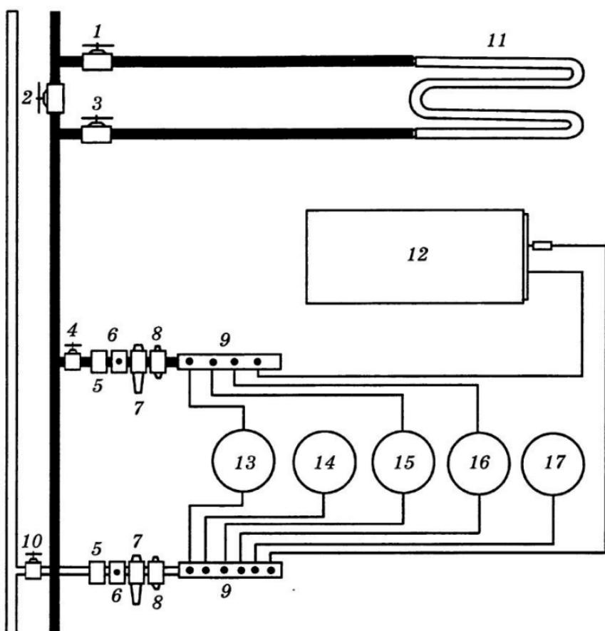
*Рис. 15. Коллекторная схема разводки водопровода: 1 — шаровой кран на полотенцесушитель (подача); 2 — шаровой кран на перемычку байпас; 3 — шаровой кран на полотенцесушитель (обратка); 4 — шаровой кран на горячую воду; 5 — фильтр грубой очистки; 6 — счетчик воды; 7 — фильтр тонкой очистки; 8 — редуктор давления; 9 — коллектор; 10 — шаровой кран на холодную воду; 11 — полотенцесушитель; 12 — водонагреватель; 13 — кухонная мойка; 14 — стиральная машина; 15 — умывальник; 16 — ванна; 17 — унитаз*
