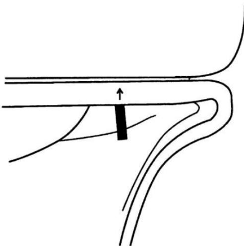
*Рис. 86. Установка бачка на полочку унитаза*
