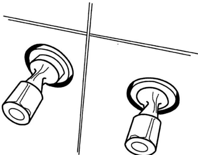
*Рис. 74. Накрученные эксцентрики смесителя*
