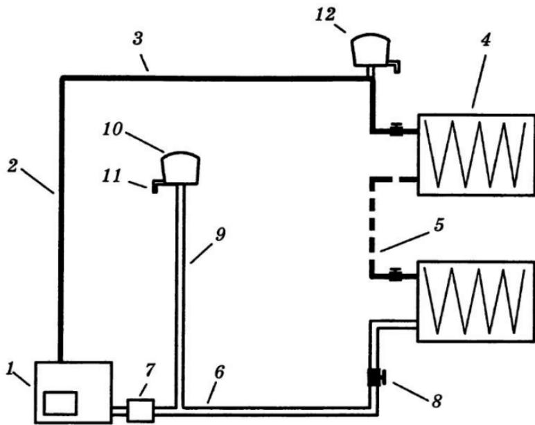
Рис. 47. Схема проточной однотрубной системы отопления:
