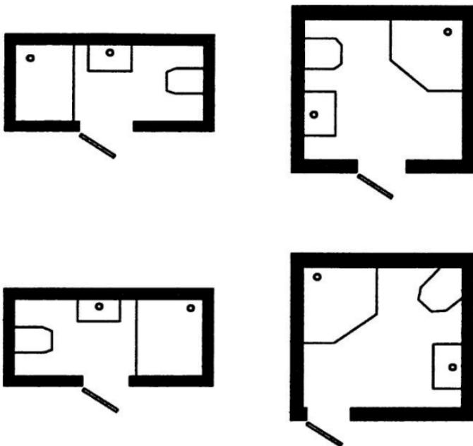
Рис. 41. Санузлы разной планировки
