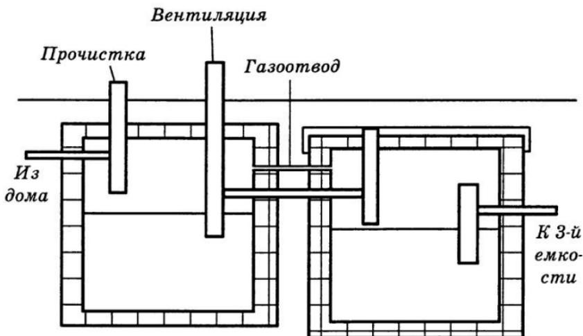
Рис. 31. Схема двухкамерного септика
