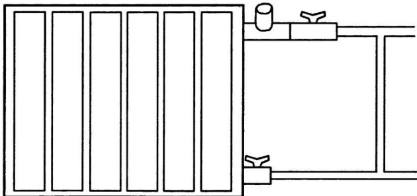
Рис. 49. Автоматическая регулировка радиатора с помощью терmostата
