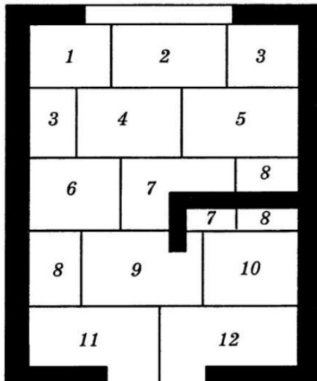
*Рис. 65.* Схема последовательности укладки теплоизоляционных плит
