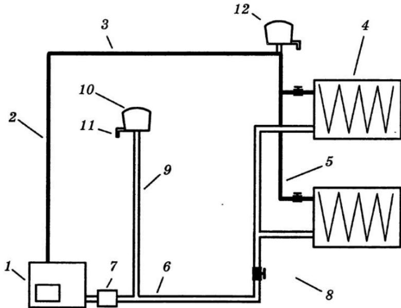
*Рис. 48. Двухтрубная система отопления:*
