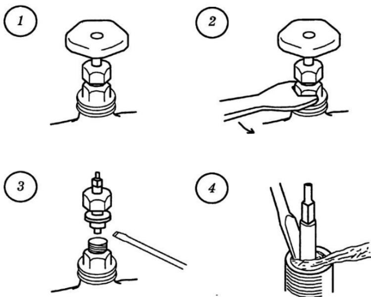
*Рис. 96. Последовательность замены набивки сальника*
