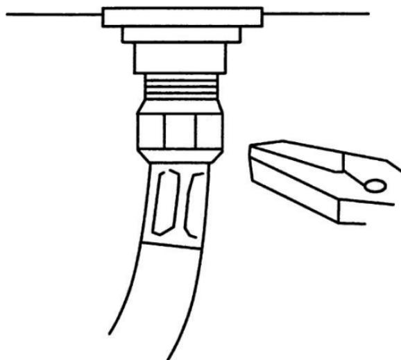
Рис. 87. Подсоединение бачка к водопроводу
