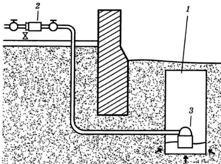
Рис. 21. Схема прокладки водопровода под фундаментом:
