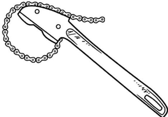
*Рис. 2. Трубный цепной ключ*
