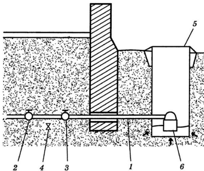
Рис. 22. Схема прокладки водопровода сквозь фундамент:
