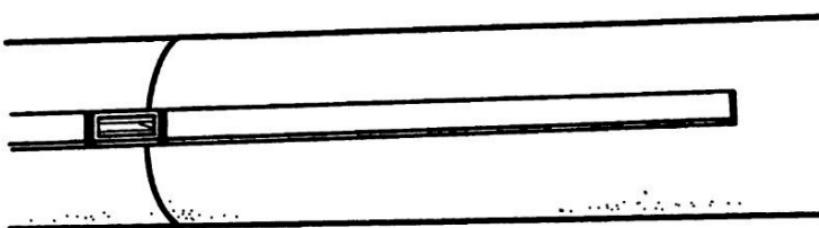
Рис. 30. Контрольный замер уклона труб
