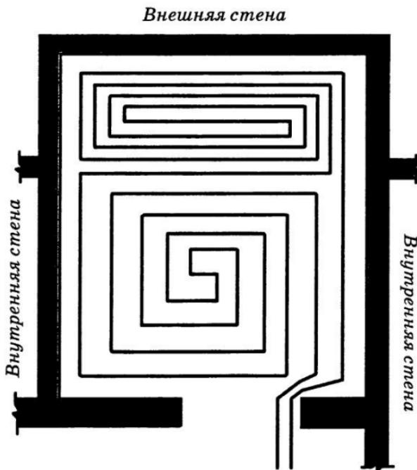
Рис. 67. Схема укладки труб
