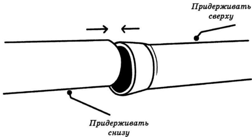
Рис. 27. Стыковка труб вручную
