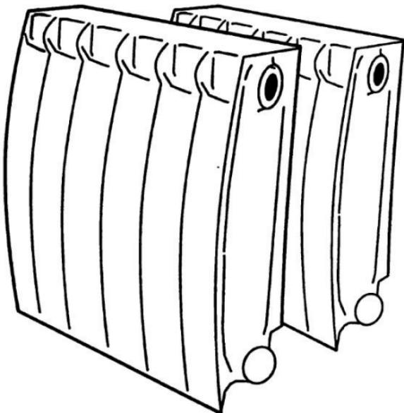
Рис. 50. Биметаллические радиаторы
