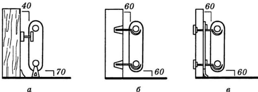
Рис. 54. Монтаж чугунных радиаторов: а — у деревянной стены; б — у кирпичной оштукатуренной стены; в — у стены облегченной конструкции (мм)
