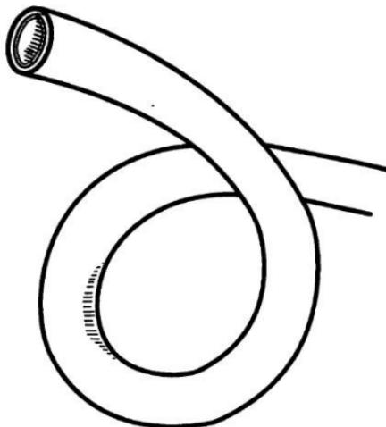
*Рис. 11. Металлопластиковая труба*
