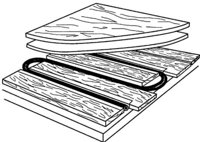
Рис. 70. Деревянная система теплых полов
