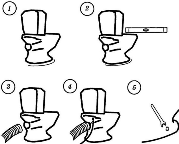
*Рис. 82. Последовательность монтажа отдельно стоящего унитаза*
