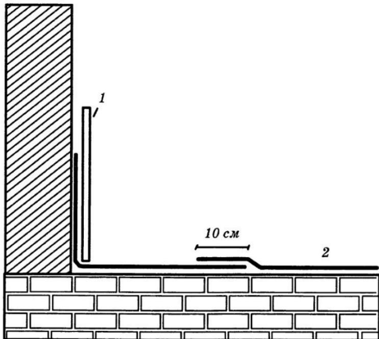
Рис. 63. Пароизоляция теплого пола: 1 — демпферная лента; 2 — полиэтиленовая пленка
