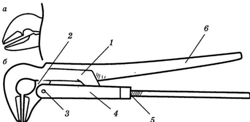
Рис. 4. Трубные рычажные ключи: *а* — с неподвижным рычагом, изготовленным из стальной полосы; *б* — с неподвижным рычагом корытообразной формы, изготовленным из тонкой листовой стали; 1 — подвижный рычаг; 2 — опорный штифт; 3 — заклепка; 4 — поводок; 5 — гайка; 6 — неподвижный рычаг
