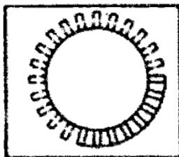
Если детали арматуры обладают центральной частью с диаметром, превышающим 35 мм, то отверстие под такую арматуру необходимо увеличить. Для этого при помощи ножовочного полотна и прорезной узкой ножовки расширяют отверстие в форме звездочки (см. рисунок). Потом клеммами аккуратно выламывают появляющиеся пластины.
