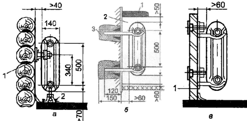
Крепление радиаторов в соответствии с типом стены: а — стена деревянная: 1 — планка; 2 — подставка; б — стена кирпичная оштукатуренная: 1 — подоконник; 2 — ниша; 3 — кронштейн; в — стена облегченной конструкции: 1 — кронштейн с цельной опорой.
