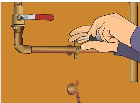
Рис. 10.302. Крепим трубу к стене с помощью хомутов
