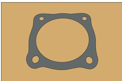
Рис. 1.34. Новая прокладка из паронита по образцу старой
