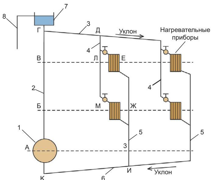
**Рис. 12.36.** Схема системы водяного отопления с естественной циркуляцией (верхняя разводка):
