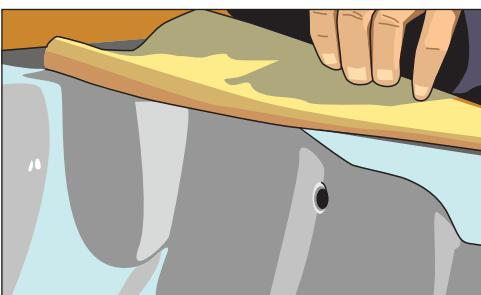
Рис. 11.9. Закрываем переливное отверстие полотенцем или заклеиваем скотчем
