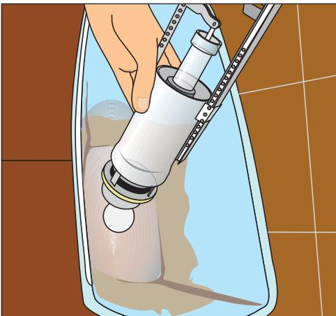
Рис. 11.77. Вставляем новое устройство слива в бачок
