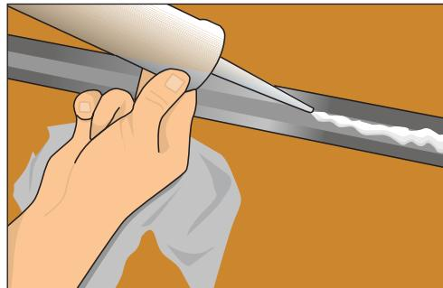
Рис. 10.225. Обрабатываем швы герметиком
