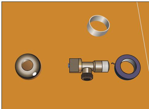
**Рис. 10.98.** Перед установкой крана наматываем ФУМ-ленту или сантехнический лен по направлению резьбы; для установки крана также понадобится металлическое кольцо, а под него резиновая прокладка (кольцо выполняет декоративную функцию и обеспечивает дополнительную герметизацию)
