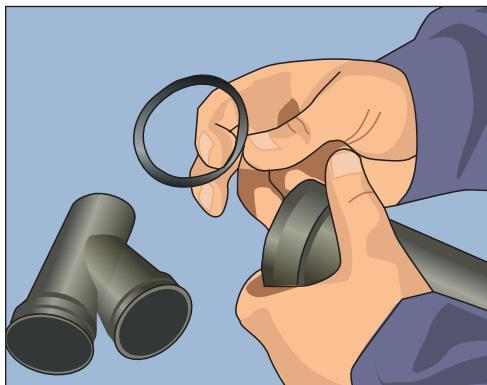
Рис. 8.16. Используем для соединения двух труб резиновую прокладку
