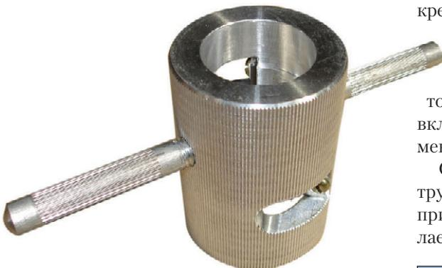
**Рис. 4.57.** Зачистной инструмент
