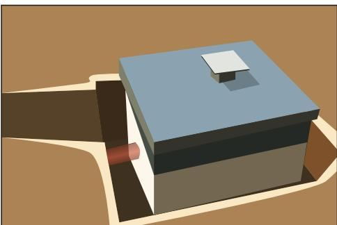
Рис. 8.44. Проводим трубопровод от дома к септику
