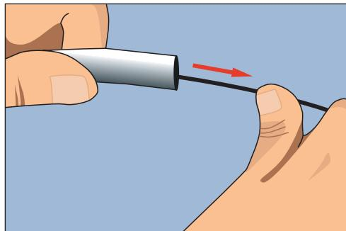
**Рис. 4.81.** Вытягиваем приспособление бечевкой или проводом послегибы
