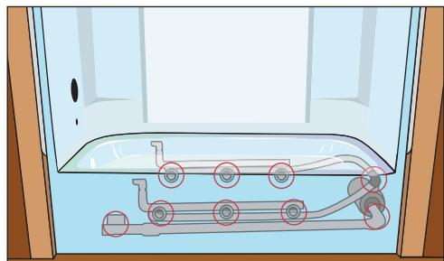
Рис. 10.207. Проверяем основные места соединений на наличие течи
