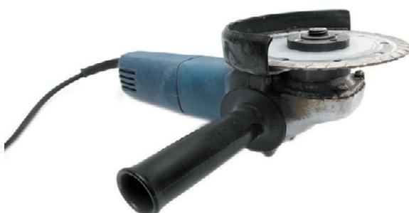
Рис. 1.14. Углошлифовальная машина с защитным кожухом
