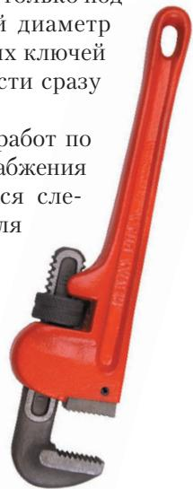
Рис. 1.5. Газовый ключ Стиллсона
