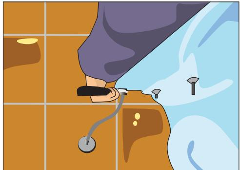
Рис. 10.83. Отсоединяем подводящий шланг (откручиваем гайку рожковым ключом 19 × 22)
