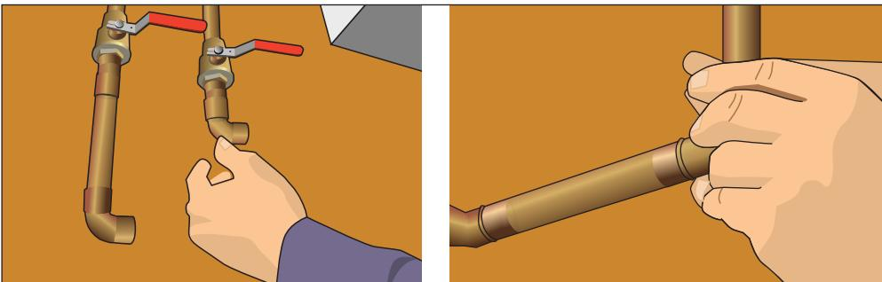
**Рис. 10.301.** Первый поворот водопровода образован при помощи колена (слева), в которое вставляется второй отрезок трубы (справа)
