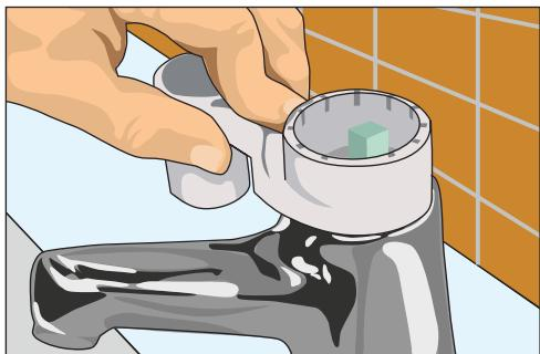
**Рис. 11.30.** Отворачиваем накидную гайку
