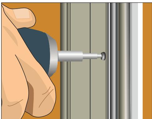
**Рис. 10.218.** Прикручиваем профили с помощью шуроповерта
