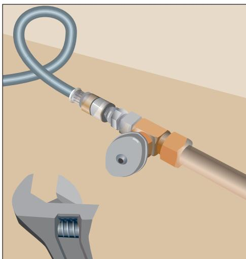
**Рис. 10.257.** Подсоединеный гибкий шланг подачи холодной воды
