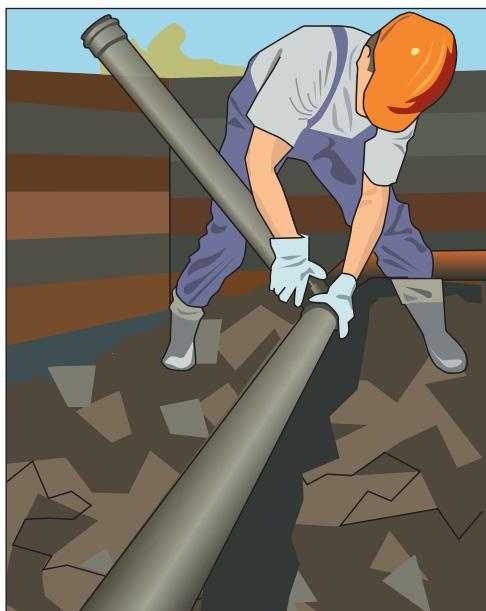
**Рис. 8.37.** Сборка труб в небольшие звенья по 3–4 штуки
