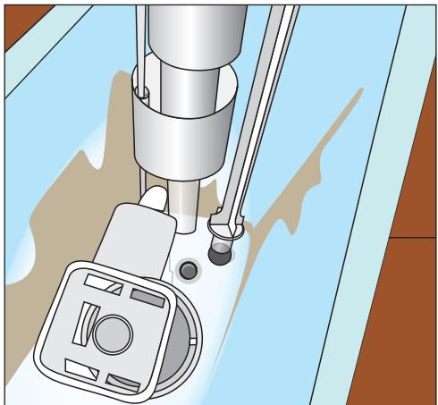
Рис. 11.80. Вставляем устройство подачи воды в бачок
