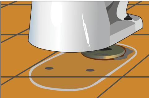
**Рис. 10.85.** Снимаем унитаз
