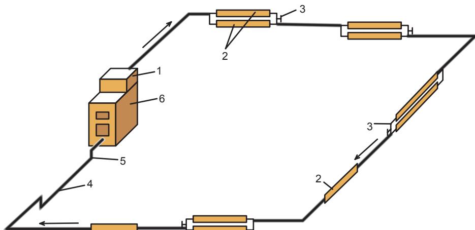
**Рис. 12.46.** Схема горизонтальной системы водяного отопления (стрелкой показано направление движения воды): 1 — расширительный бачок; 2 — нагревательные приборы; 3 — запорная арматура; 4 — обводка дверей; 5 — спуск воды из системы; 6 — котел
