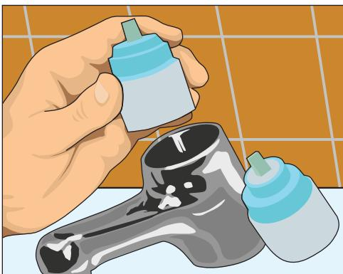
Рис. 11.31. Снимаем старый картридж, на его место устанавливаем новый
