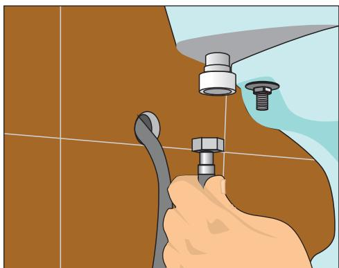
Рис. 11.68. Отсоединяем шланг подачи воды в бачок
