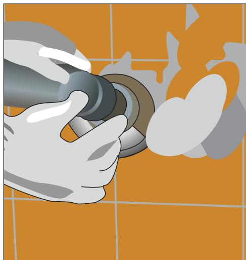
Рис. 10.37. Убираем старые шурупы с резьбой
