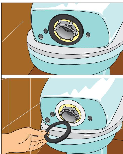
Рис. 11.73. Снимаем уплотнительное кольцо из резины (сверху), расположенное в основании бачка (снизу)
