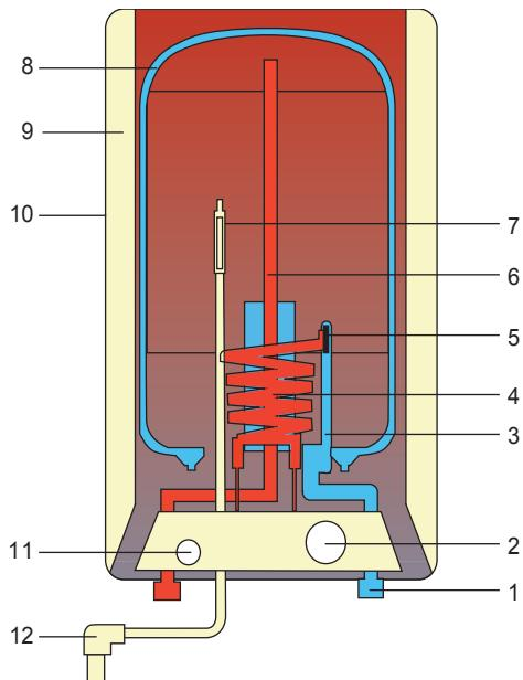
**Рис. 10.280.** Устройство накопительного водонагревателя: 1 — труба для забора холодной воды; 2 — регулятор температуры; 3 — потокогаситель; 4 — нагревательный элемент (ТЭН); 5 — предохранительный элемент; 6 — труба вывода горячей воды; 7 — температурный датчик; 8 — внутренняя емкость; 9 — теплоизолирующий наполнитель; 10 — корпус; 11 — контрольный датчик (лампочка); 12 — кабель
