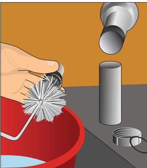
**Рис. 11.24.** Разобранные части сифона можно также промыть и прочистить ёршом
