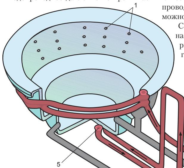
**Рис. 10.199. Устройство джакузи:**
