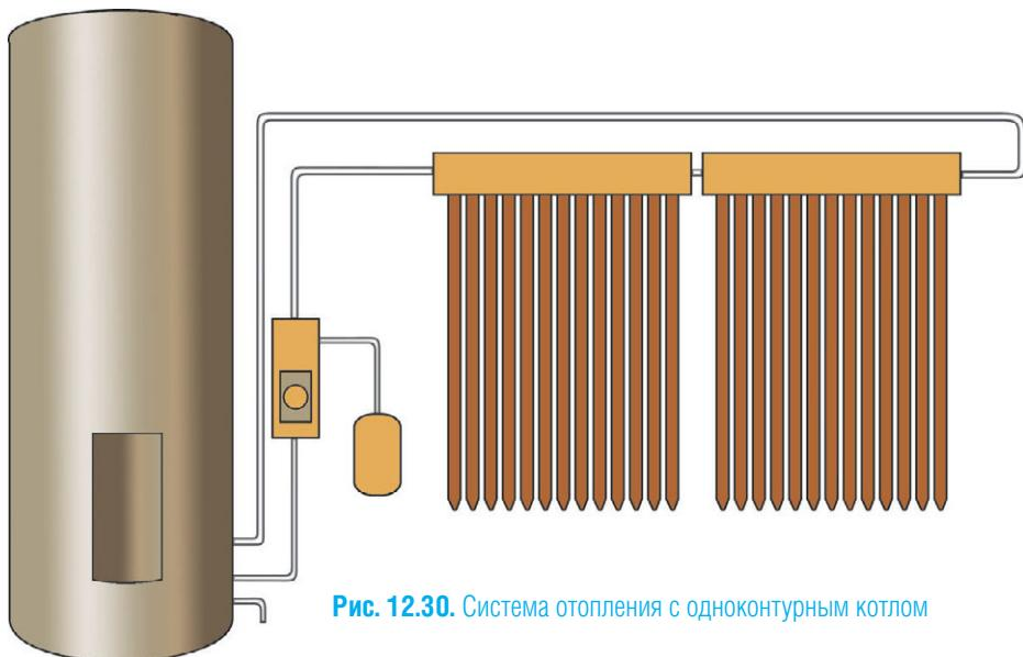
Рис. 12.30. Система отопления с одноконтурным котлом
