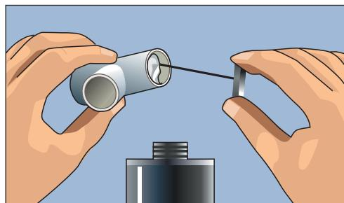
Рис. 4.70. Смазываем поверхность фитинга в месте соединения kleem
