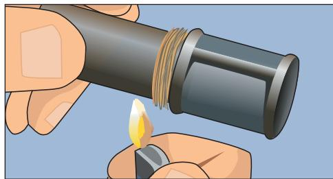
Рис. 1.28. Удаляем лишние волокна льна с помощью огня
