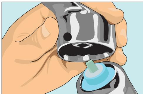
**Рис. 11.29.** Снимаем ручку смесителя
