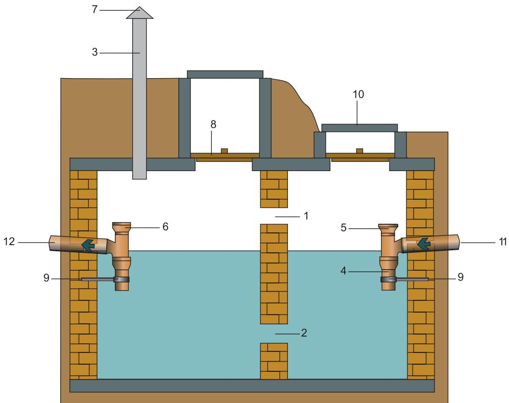
**Рис. 8.30.** Устройство кирпичного септика: 1 — воздушное отверстие  $250 \times 250$  мм; 2 — переливное отверстие  $250 \times 250$  мм; 3 — вентиляционная труба; 4 — удлиняющий чугунный патрубок; 5 — впускной тройник; 6 — выпускной тройник; 7 — флюгарка; 8 — утепленная деревянная крышка; 9 — крепежный хомут; 10 — крышка люка; 11 — подводящий трубопровод диаметром 100 мм; 12 — отводящий трубопровод диаметром 100 мм
