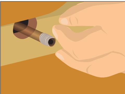
**Рис. 10.22.** Смазываем предварительно место соединения смесителя и гибкого шланга сурником во избежание течи
