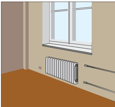
Рис. 12.59. При правильном монтаже радиатор жестко опирается на все 4 опоры
