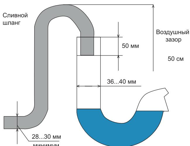
**Рис. 10.247.** Подключение стиральной машины к канализации
