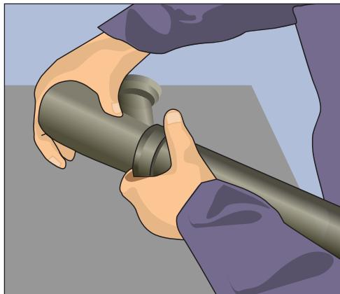
Рис. 8.17. Собираем короткие отрезки трубопровода
