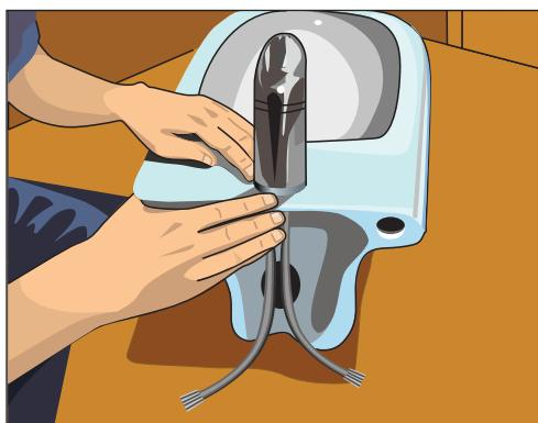
**Рис. 10.144.** Прикручиваем гибкие шланги горячей и холодной воды
