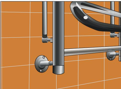
Рис. 12.75. Подвод горячей воды осуществляется с помощью пластиковых труб, которые укладываем в стену; крепление производим с помощью пресс-фитингов
