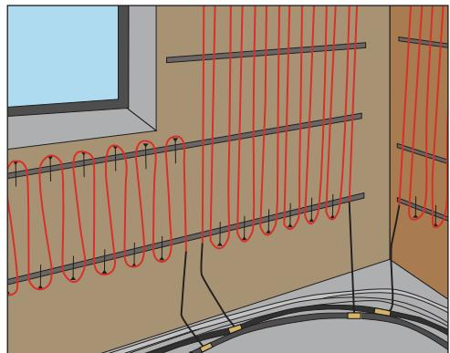
Рис. 12.17. Укладка теплых стен по периметру комнаты
