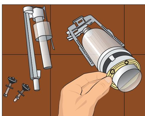
Рис. 11.76. Одеваем уплотнительное кольцо из резины на новое сливное устройство
