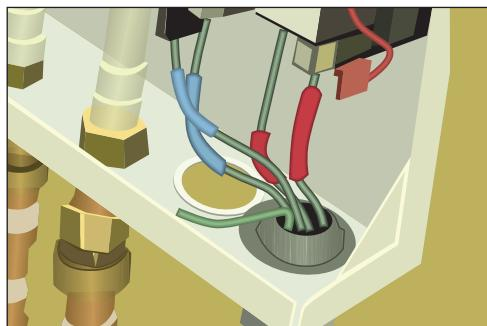
Рис. 10.276. Провода, подсоединеные к клеймам
