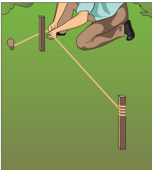
**Рис. 8.35.** Размечаем колышками и шнуром расположение трубопровода
