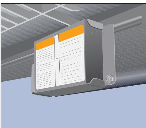
Рис. 10.259. Электрическая коробка посудомоечной машины
