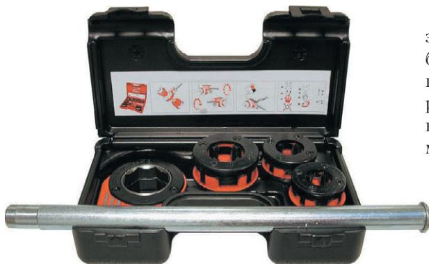
**Рис. 1.7.** Клупп имеет насадки для труб различного диаметра
