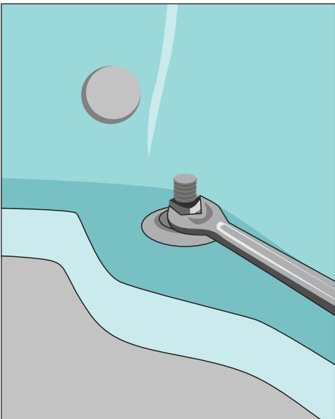
**Рис. 10.46.** Устанавливаем раковину на стержневые болты, гайки закручиваем не до конца
