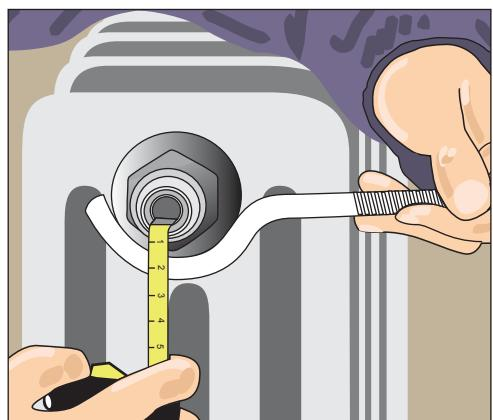
Рис. 12.57. Измеряем расстояние от центра сечения входной трубы
