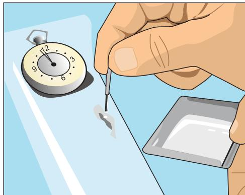
Рис. 11.88. Нанесение краски на трещину
