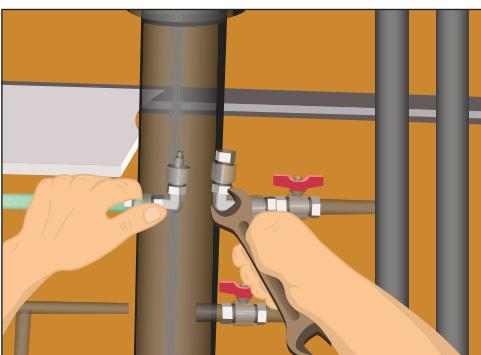
**Рис. 6.7.** Устанавливаем на входе в счетчик счетный фильтр, чтобы в прибор не попадал осадок
