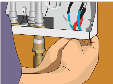
**Рис. 10.303.** Подсоединяя водонагреватель к системе электроснабжения
