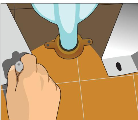
Рис. 10.129. Примеряем цельнолитый сифон к отверстию канализации
