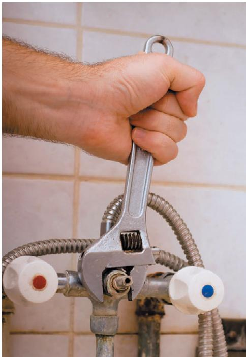
Рис. 1.4. Разводной ключ в работе
