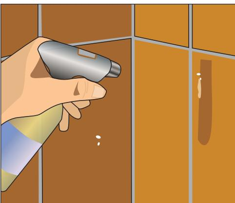
Рис. 1.39. Наносим фунгицидное средство на место замены герметика
