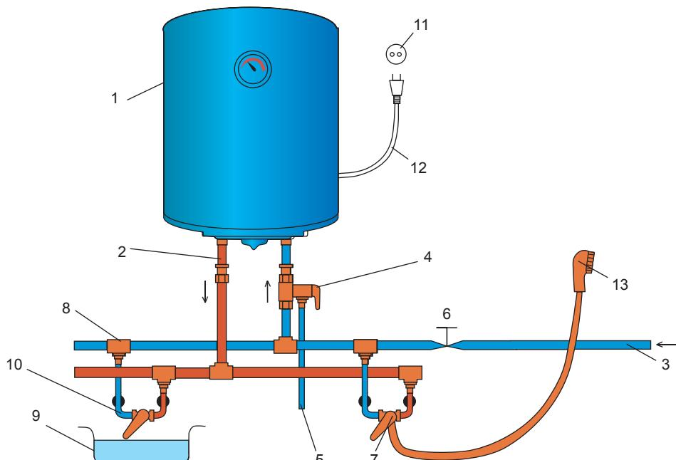
**Рис. 10.287.** Подключение накопительного водонагревателя к водопроводу: 1 — корпус водонагревателя; 2 — выводная труба для горячей воды; 3 — труба для подачи воды; 4 — односторонний предохранительный клапан; 5 — выводной шланг для воды при избыточном давлении; 6 — вентиль для входящей воды; 7 — смеситель воды; 8 — соединительная втулка для труб; 9 — раковина для воды; 10 — соединительная втулка для труб; 11 — электрическая сеть; 12 — провод электропитания; 13 — душ
