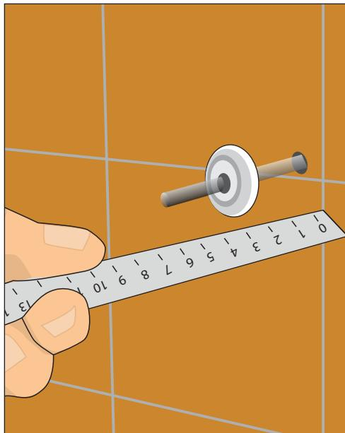
Рис. 10.43. Измерив толщину крепежной подвески раковины, вкручиваем в стену стержневые болты
