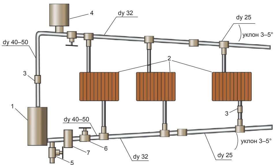
**Рис. 12.26.** Схема подключения электрокотла: 1 — котел; 2 — радиатор отопления с запорным вентилем; 3 — датчик-реле температуры; 4 — расширительный бак; 5 — сливной вентиль; 6 — запорный вентиль; 7 — фильтр с циркуляционным насосом
