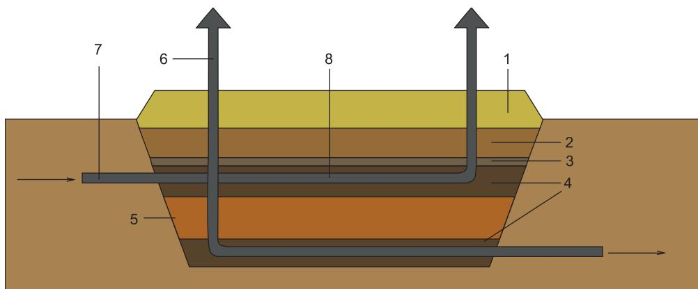
**Рис. 8.33.** Устройство песчано-гравийных фильтров: 1 — утепляющая обсыпка; 2 — глинистый замок; 3 — гидроизоляция; 4 — зона орошения (щебень); 5 — песок; 6 — вентиляционный стояк; 7 — подводящий трубопровод; 8 — оросительные трубы
