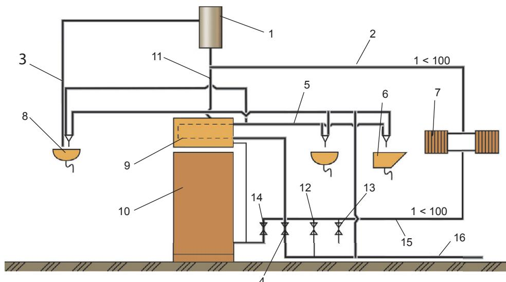
**Рис. 12.45.** Схема монтажа зимнего отопления: 1 — бачок расширительный; 2 — подающий трубопровод; 3 — переливная труба; 4 — вентиль вододогревателя; 5 — трубопровод горячей воды; 6 — ванная; 7 — радиаторы; 8 — раковина; 9 — водоподогреватель; 10 — котел; 11 — главный стояк; 12 — вентиль для подпитки системы; 13 — спускной вентиль; 14 — вентили; 15 — обратный трубопровод; 16 — водопровод
