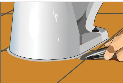
**Рис. 10.84.** Воспользуемся резаком для снятия унитаза, если он был посажен на клей
