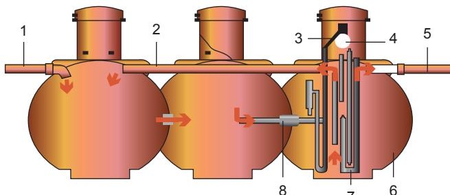
**Рис. 8.34.** Современная система очистки сточных вод на основе септика: 1 — подводящий канализационный трубопровод; 2 — возвращение осадка; 3 — устройство дозирования; 4 — осадочный химикат; 5 — отводящий трубопровод; 6 — поверхность осадка; 7 — аэрация; 8 — процесс подачи
