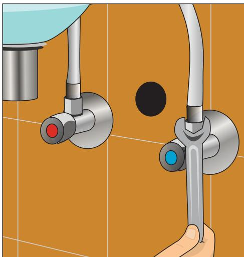
Рис. 10.35. Откручиваем накидные гайки
