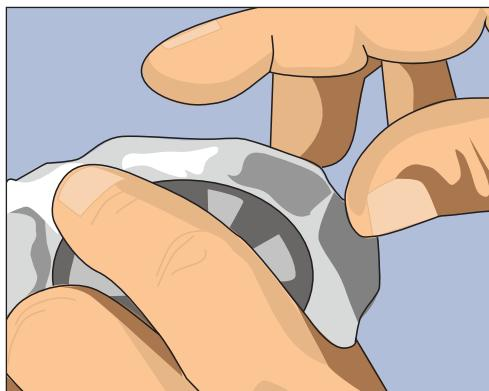
Рис. 10.19. При отсутствии уплотнительного резинового кольца герметизируем с помощью пластиичного герметика на полимерной основе
