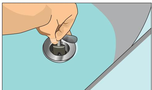
Рис. 10.175. Затягиваем решетку крепежным болтом
