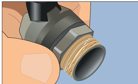
Рис. 1.25. Лен, идеально намотанный на резьбу
