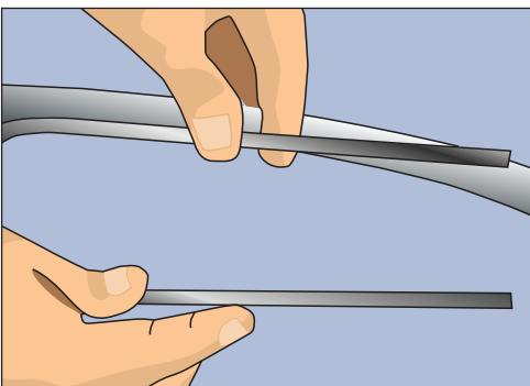
Рис. 4.76. Внутренняя оправка для гибки металлопластиковых труб
