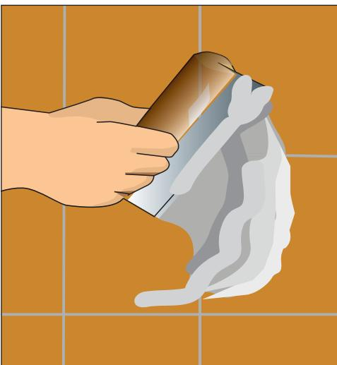
**Рис. 10.39.** Заполняем отверстия и трещины на стене шпаклевочным раствором, поверхность выравниваем
