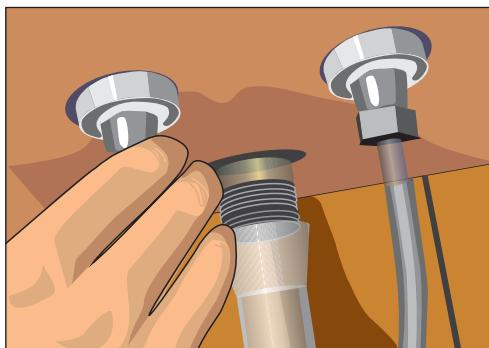
Рис. 10.151. Подсоединяя шланги горячего и холодного водоснабжения
