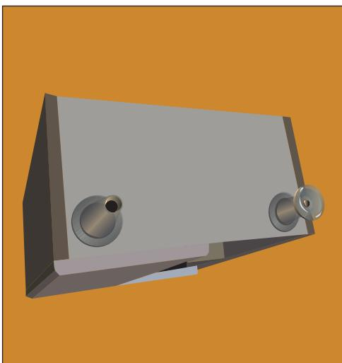
Рис. 10.59. Прикручиваем к тумбе ножки
