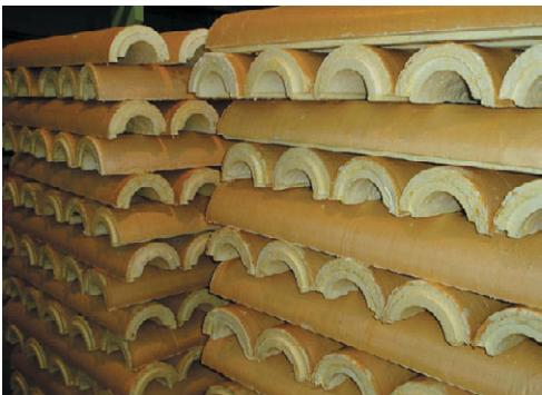
Рис. 5.8. Скорлупа пенополиуретановая
