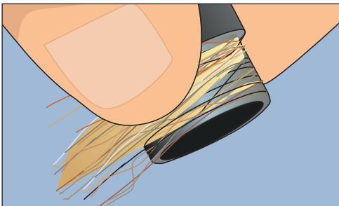
Рис. 1.21. Прикладываем лен вдоль резьбы, прижимаем пальцем
