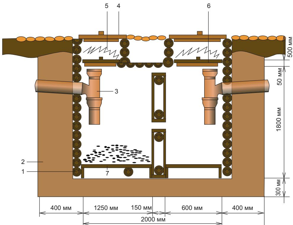
Рис. 8.29. Устройство двухкамерного септика из бревен: 1 — стена септика из бревен диаметром 120 мм; 2 — глинистый замок; 3 — тройник; 4 — верхний люк; 5 — утеплитель (солома); 6 — нижний люк; 7 — переливное отверстие
