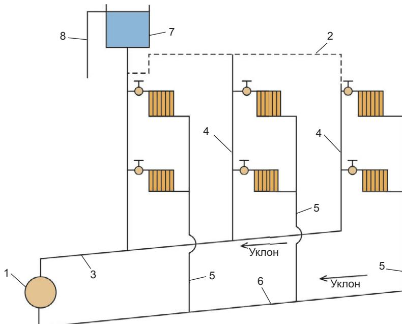
**Рис. 12.37.** Схема системы водяного отопления с естественной циркуляцией (нижняя разводка):
