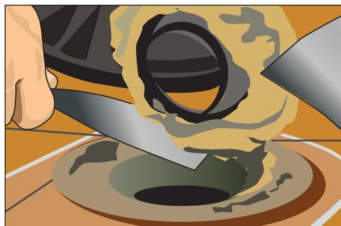
**Рис. 10.86.** Убираем старую резиновую прокладку при демонтаже унитаза с вертикальным выпуском вместо раstra
