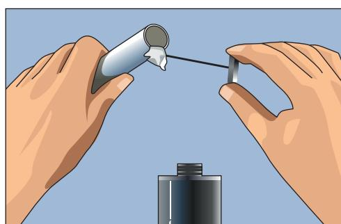
Рис. 4.71. Наружную часть трубы в месте соединения также смазываем kleem
