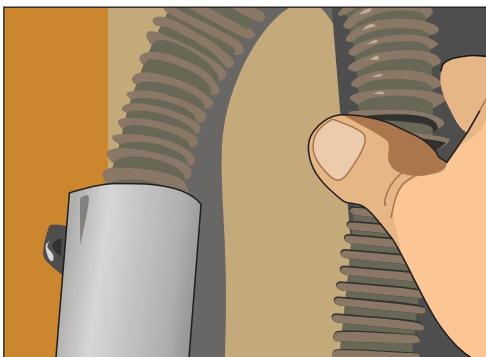
**Рис. 10.245.** Устанавливаем отводную трубу стиральной машины
