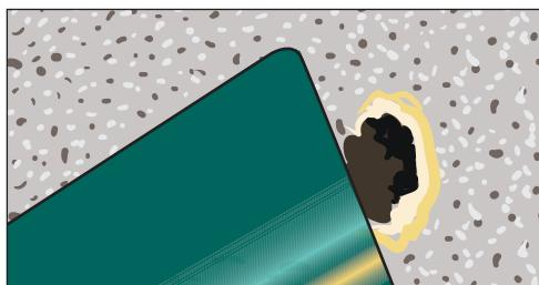
**Рис. 1.53.** Выдуваем пылесосом каменную крошку из проделанного отверстия
