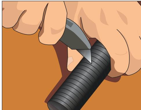
Рис. 10.131. Отрезаем трубу резаком с широким лезвием
