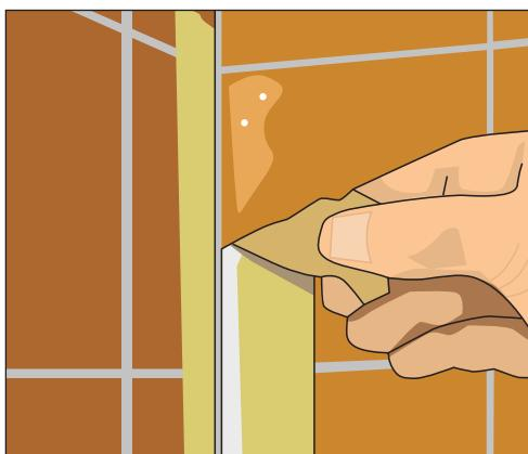
**Рис. 1.46.** Удаляем малярную ленту, разглаживаем герметик руками
