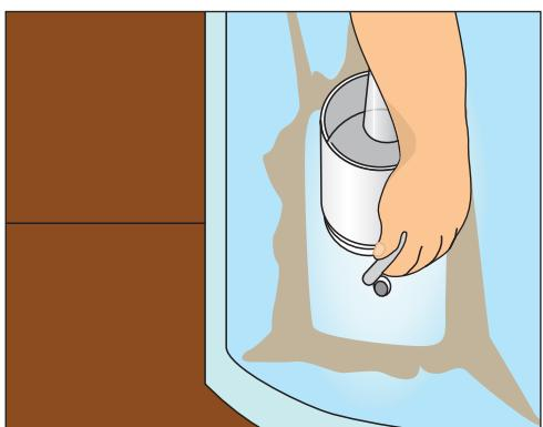
Рис. 11.82. Вставляем болты с резиновыми прокладками внутрь бачка
