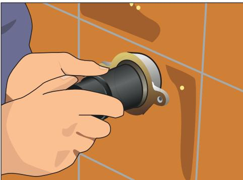
**Рис. 10.132.** Вставляем патрубок в растрub канализации, предварительно нанеся на него сурик
