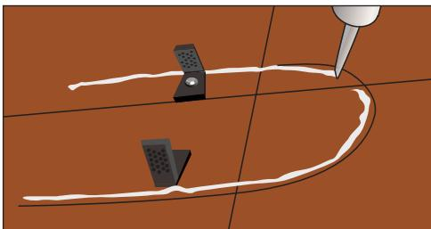
Рис. 10.106. Наносим герметик по контуру унитаза перед соединением
