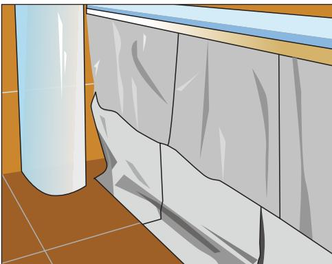
Рис. 11.106. Подготавливаем ванну к нанесению акрила (зашщщаем другие прилегающие к ванне поверхности)
