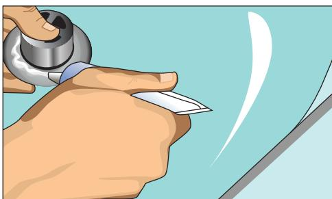
Рис. 10.173. Перед установкой на сливную решетку наносим герметик
