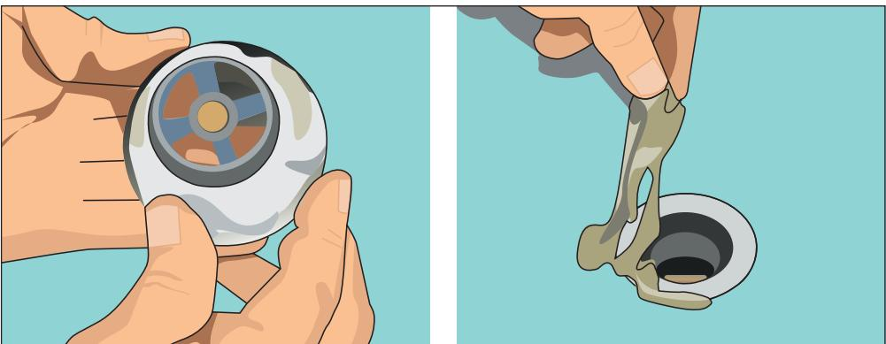
**Рис. 11.58.** В новом сливе кладем на края пластичный герметик на полимерной основе (слева) или резиновую прокладку на отверстие, остатки которых удаляем после установки (справа)
