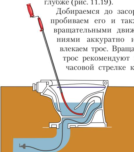
**Рис. 11.19.** Прочистка засора с помощью специального троса
