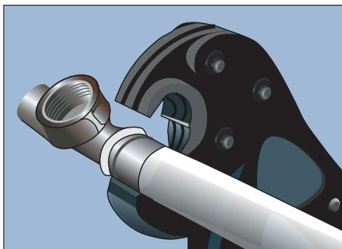
**Рис. 4.45.** Обжимаем муфту ручными или электрическими пресс-клещами (открываем пресс-клещи и вставляем часть, которую будем прессовать непосредственно над стальной гильзой; закрываем вставки пресс-клещей над гильзой и фиксируем)
