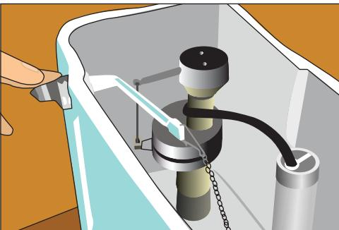
Рис. 10.80. Сливаем всю воду из бачка унитаза
