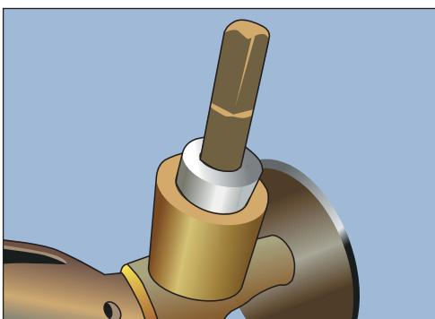
Рис. 1.31. Обмотка из ФУМ-ленты на участке трубы
