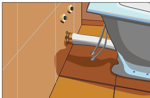
Рис. 10.150. Подсоединяя отводную трубу к раструбу канализации
