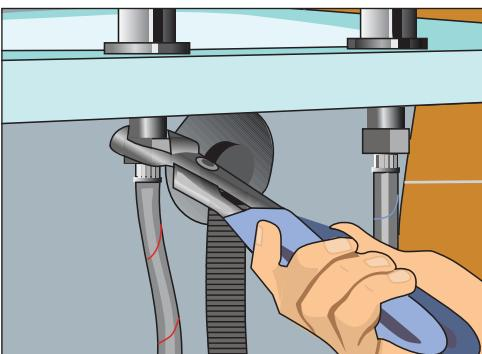
Рис. 10.54. Откручиваем гайки, которые соединяют смеситель со шлангами горячего и холодного водоснабжения
