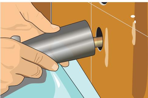
Рис. 10.185. Устанавливаем смеситель (слева) и душ (справа)
