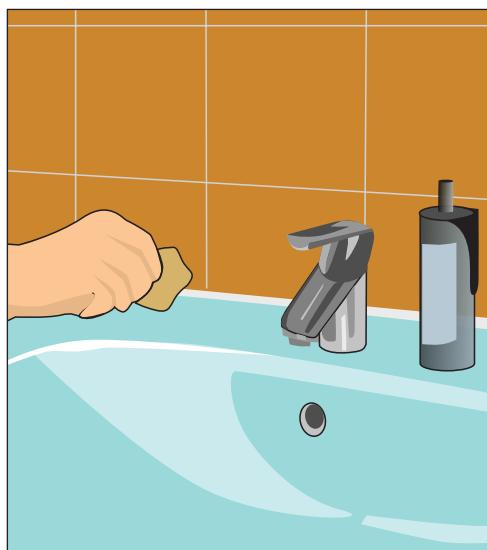
**Рис. 10.50.** Проверяем соединения на герметичность, промежуток между стеной и раковиной заполняем силиконовым герметиком
