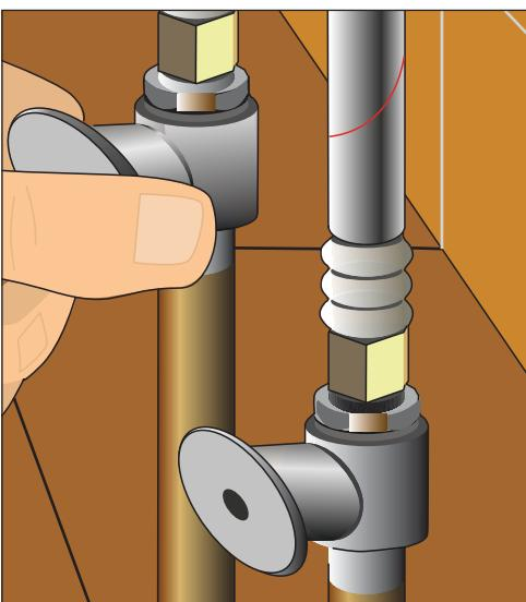
Рис. 10.52. Перекрываем вентили горячей и холодной воды
