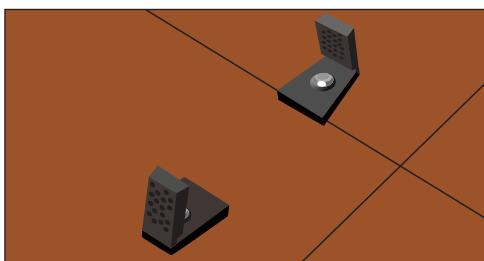
Рис. 10.105. Монтируем крепления для унитаза
