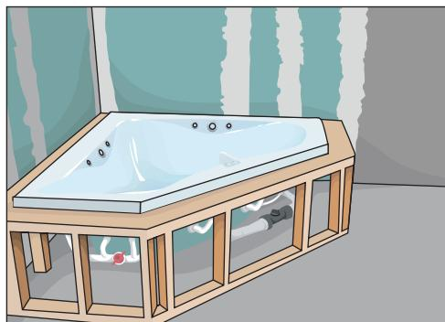
**Рис. 10.191.** Установка джакузи в деревянный каркас
