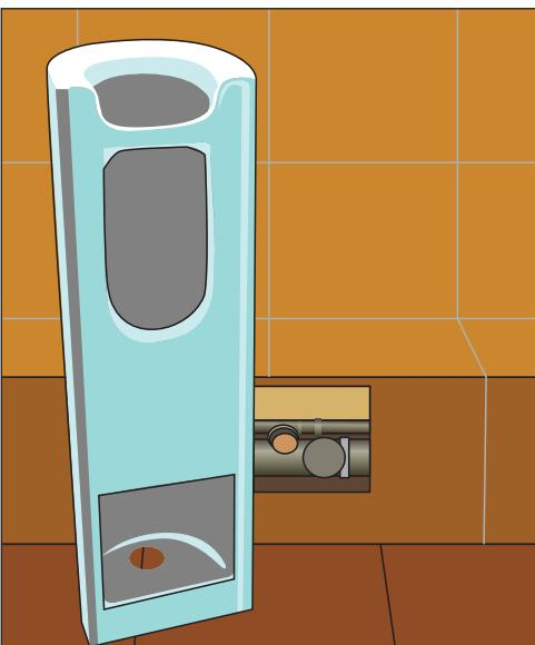
Рис. 10.65. С обратной стороны пьедестал имеет керамические перегородки
