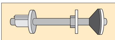
**Рис. 10.117.** Болт для крепления бачка к унитазу
