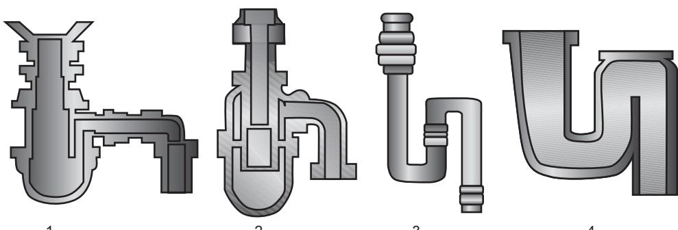
Рис. 10.5. Сантехнические сифоны: 1 — пластмассовый бутылочный; 2 — никелированный бутылочный; 3 — двухоборотный пластмассовый; 4 — сифон-ревизия
