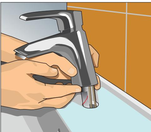
**Рис. 10.28.** Ставим смеситель в предназначенное отверстие умывальника
