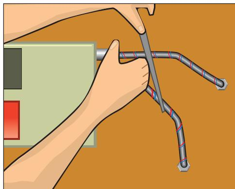
**Рис. 10.273.** Соединяем гибкой подводкой водонагреватель и водопровод
