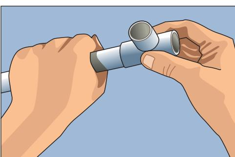
Рис. 4.68. Проверяем, подходит ли труба и фитинг друг другу по размеру (труба должна входить в фитинг на  $\frac{2}{3}$  глубины)
