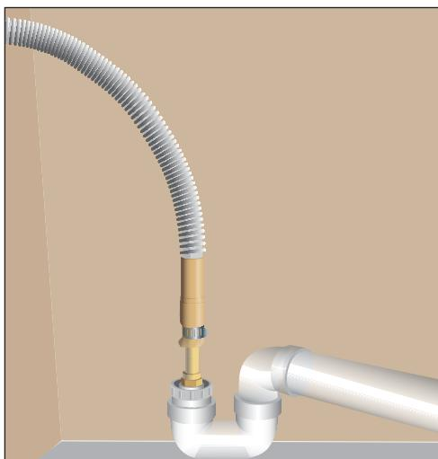
**Рис. 10.258.** Сливная труба посудомоечной машины подсоединяется к сифону
