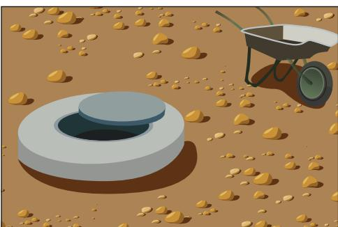
Рис. 8.45. Фильтрационный колодец
