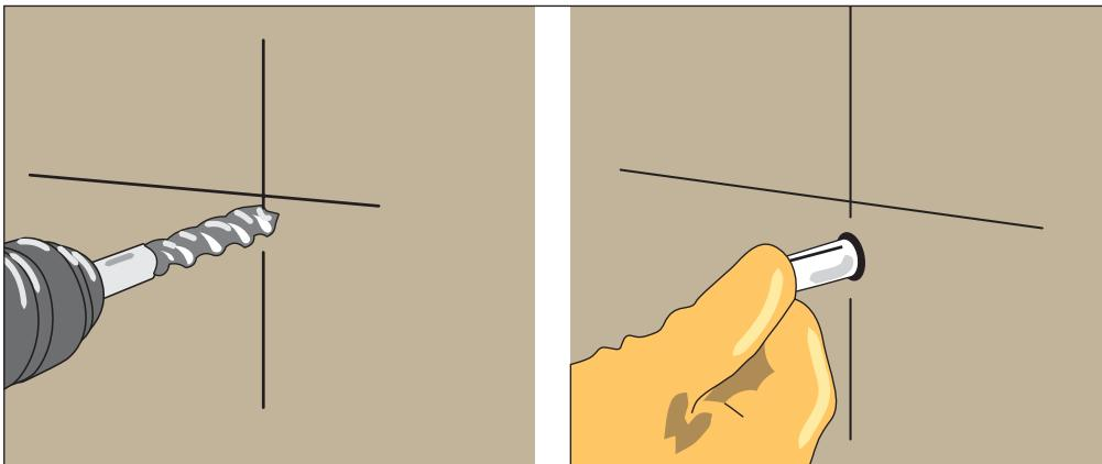
Рис. 12.58. Просверливаем отверстия (слева), вставляем дюбели (справа)
