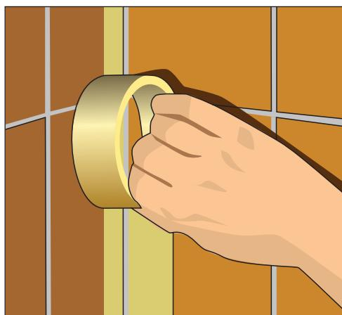
Рис. 1.42. Оклейваем поверхность стыка самоклеящейся лентой
