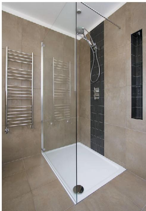
**Рис. 10.209.** Душевой угол — самый простой вариант душевой кабины
