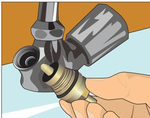
Рис. 11.34. Прочищаем все внутри, удаляем накопившиеся отложения
