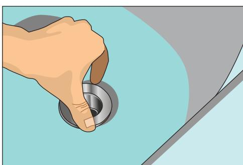
Рис. 10.174. Вставляем сливную решетку в сливное отверстие
