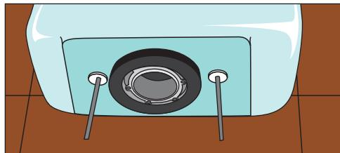
**Рис. 10.118.** Бачок с вкрученными в него болтами
