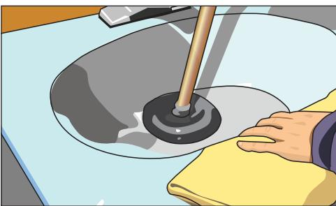
Рис. 11.10. Прижимаем вантуз к сливному отверстию раковины
