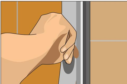
Рис. 10.223. Устанавливаем на место стыка резиновую ленту
