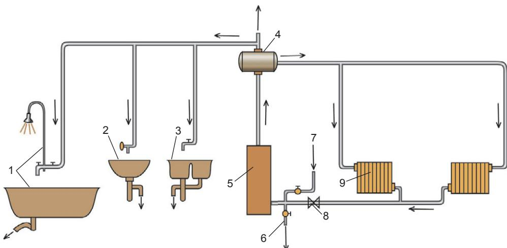
**Рис. 12.31.** Система отопления и горячего водоснабжения с двухконтурным котлом: 1 — ванна с душем; 2 — умывальник; 3 — кухонная мойка; 4 — расширительный бачок; 5 — котел; 6 — кран для спуска воды из системы; 7 — водопровод холодной воды; 8 — кран для отключения системы отопления; 9 — радиатор
