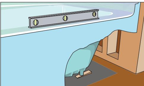
Рис. 10.201. Проверяем положение джакузи с помощью уровня
