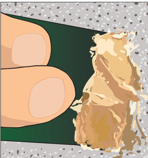
Рис. 1.54. Заполняем отверстие раствором
