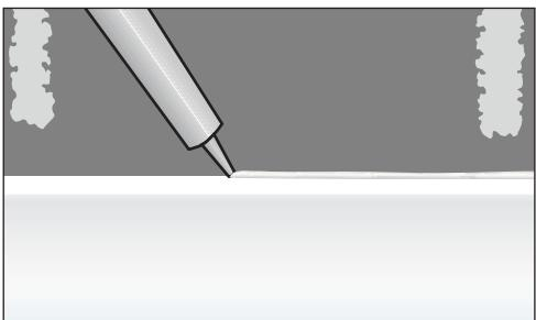
Рис. 10.203. Соединяем детали с помощью силиконового герметика
