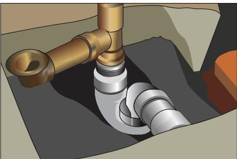
Рис. 10.181. Прикручиваем верхний конец сифона к тройнику
