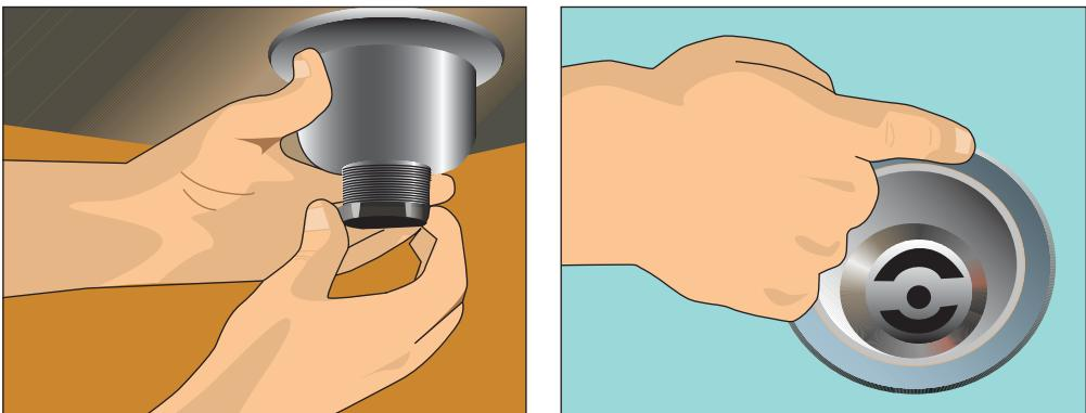
**Рис. 11.60.** Устанавливаем и закручиваем снизу сливное устройство
