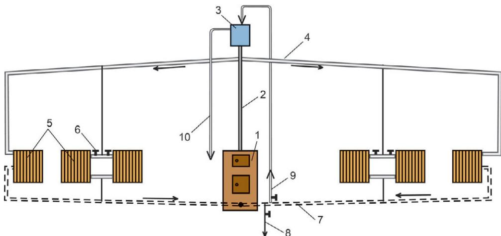
**Рис. 12.43.** Схема двухтрубной системы отопления: 1 — котел; 2 — главный стояк; 3 — расширительный бачок; 4 — разводящая линия горячей воды; 5 — нагревательные приборы; 6 — кран двойной регулировки; 7 — обратная линия; 8 — вентиль с патрубком для спуска воды из системы; 9 — подпитка системы из водопровода или от ручного насоса; 10 — переливная линия (уклон труб показан стрелками)
