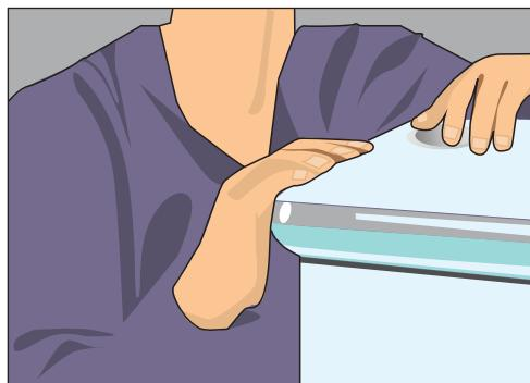
**Рис. 11.64.** Сливаем воду из бачка, снимаем кнопку смыыва (прокручиваем против часовой стрелки, оттягиваем вверх и извлекаем)
