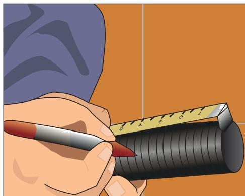
Рис. 10.130. Отмеряем нужную длину отводной трубы сифона
