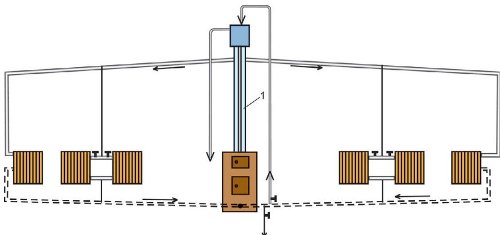
**Рис. 12.44.** Изоляция главного стояка: 1 — теплоизоляционный слой
