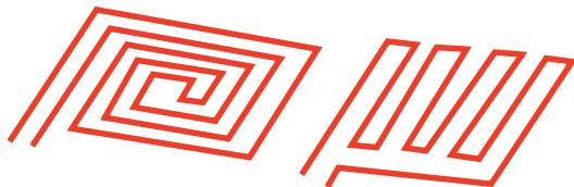
**Рис. 12.9.** Спиральный (слева) и параллельный (справа) варианты укладки теплого пола
