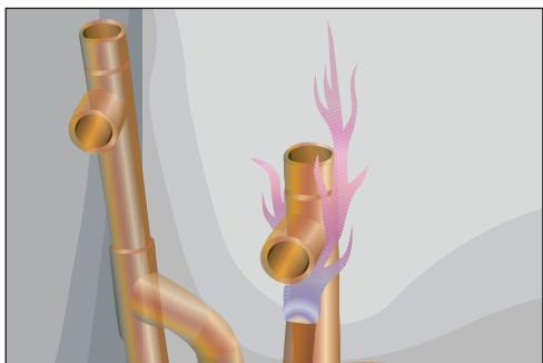
Рис. 10.183. Соединяем медные трубы методом капиллярной пайки
