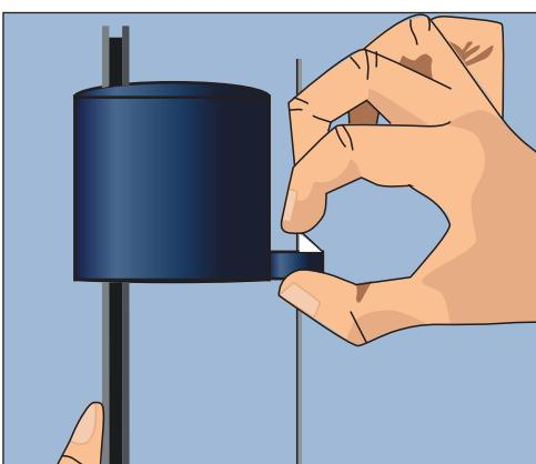
Рис. 11.67. Регулируем поплавок
