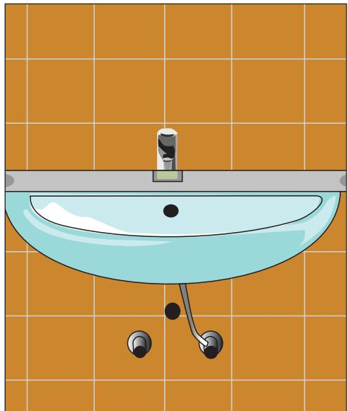
**Рис. 10.47.** Выравниваем раковину с помощью уровня
