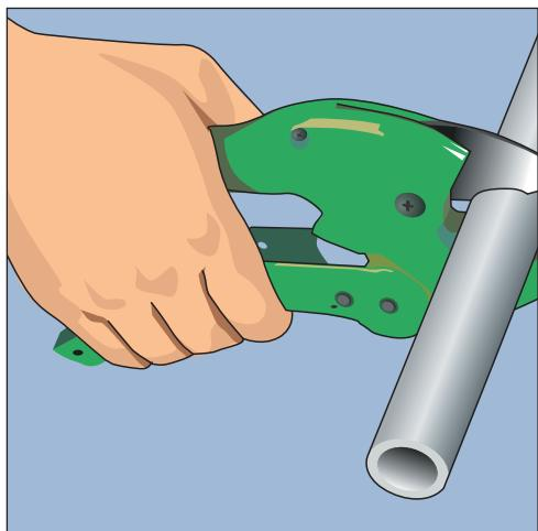
**Рис. 4.59.** Отрезаем кусок трубы необходимой длины, чистим его
