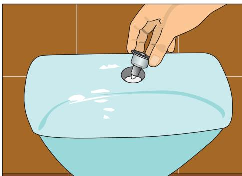
Рис. 11.86. Ставим крышку бачка, устанавливаем кнопку слива
