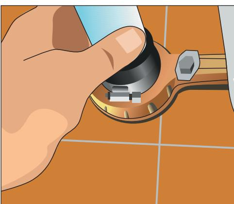
**Рис. 10.134.** Соединяем цельнолитой сифон с раstrубом канализации
