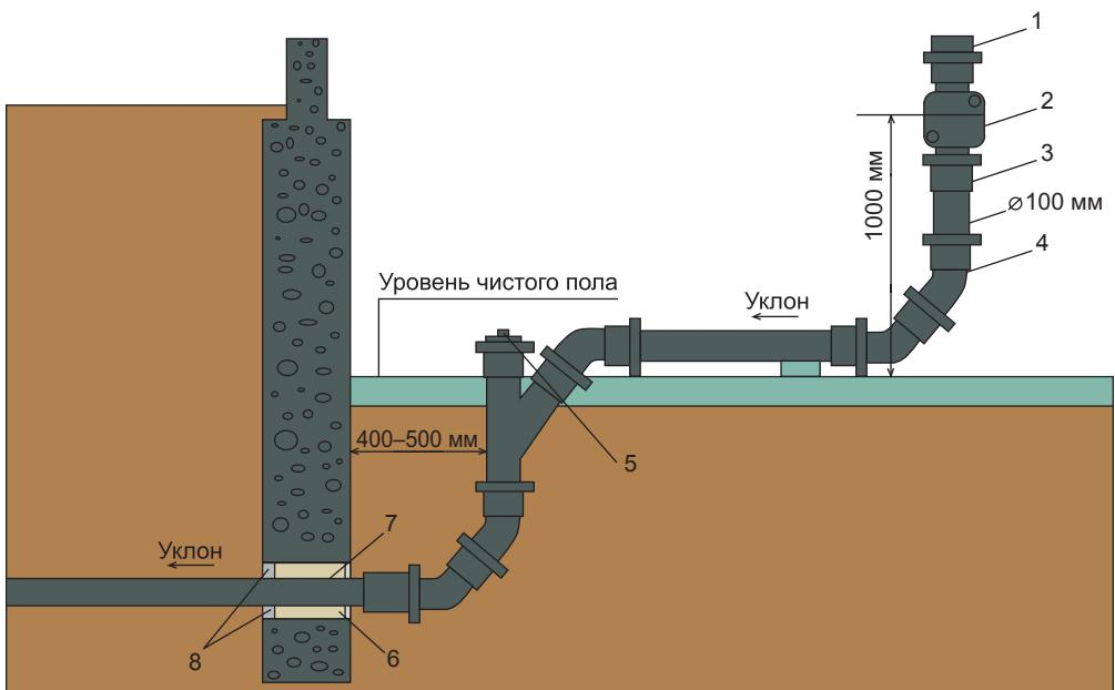
**Рис. 8.24.** Схема выпуска канализационного стояка: 1 — стояк; 2 — ревизия; 3 — крепление стальным крючком под растрюб; 4 — отвод под углом 135°; 5 — пробка прочистки; 6 — стальная гильза; 7 — забивка из смоляного каната; 8 — цементный раствор
