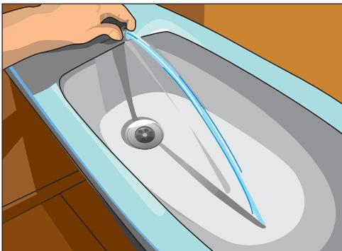
**Рис. 10.152.** Проверяем герметичность установки — включаем воду
