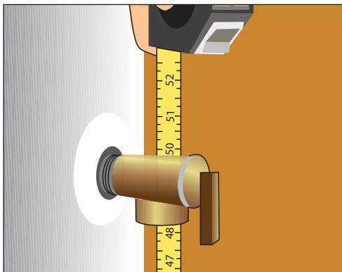
**Рис. 10.294.** Временно присоединим клапан к баку и измерим расстояние от дна клапана до пола, от полученного числа вычтем 4 дюйма — получим необходимую длину дренажной трубы
