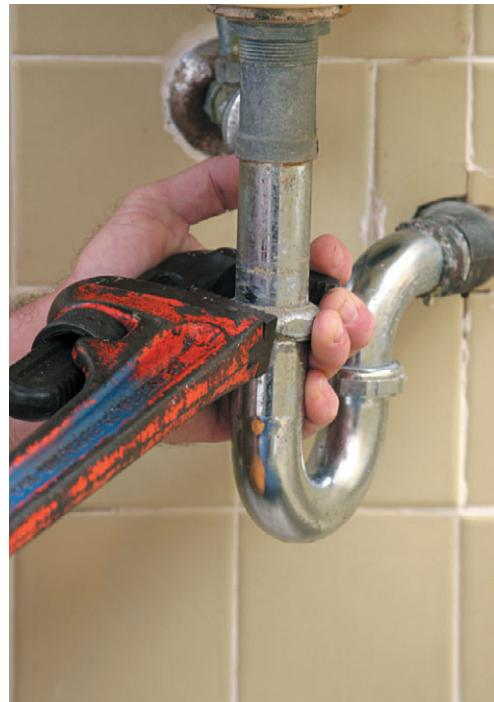
Рис. 1.6. Ключ Стиллсона в работе
