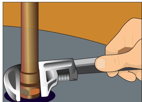
Рис. 10.291. Устанавливаем трубу на бак, соединяя с входным отверстием и затягиваем разводным ключом
