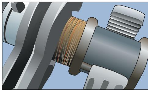
Рис. 1.27. Соединяем трубу с муфтой
