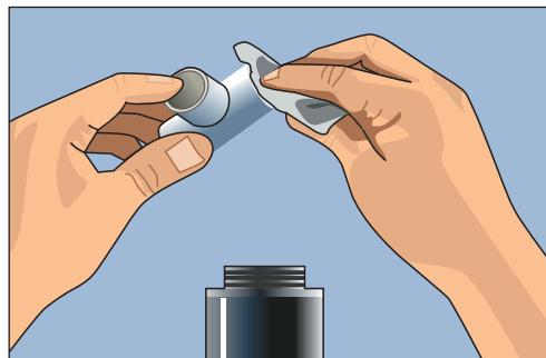
Рис. 4.69. Обрабатываем места склеивания фитинга и трубы очистителем
