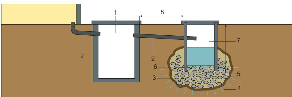
**Рис. 8.39.** Схема автономной канализационной сети: 1 — септик; 2 — труба ПВХ диаметром 110 мм; 3 — геотекстиль; 4 — фильтрация очищенной воды в грунт; 5 — щебеночная подушка; 6 — очищенная вода; 7 — железобетонный колодец без дна диаметром 1000 мм; 8 — расстояние между септиком и железобетонным колодцем (определяется условиями местности)
