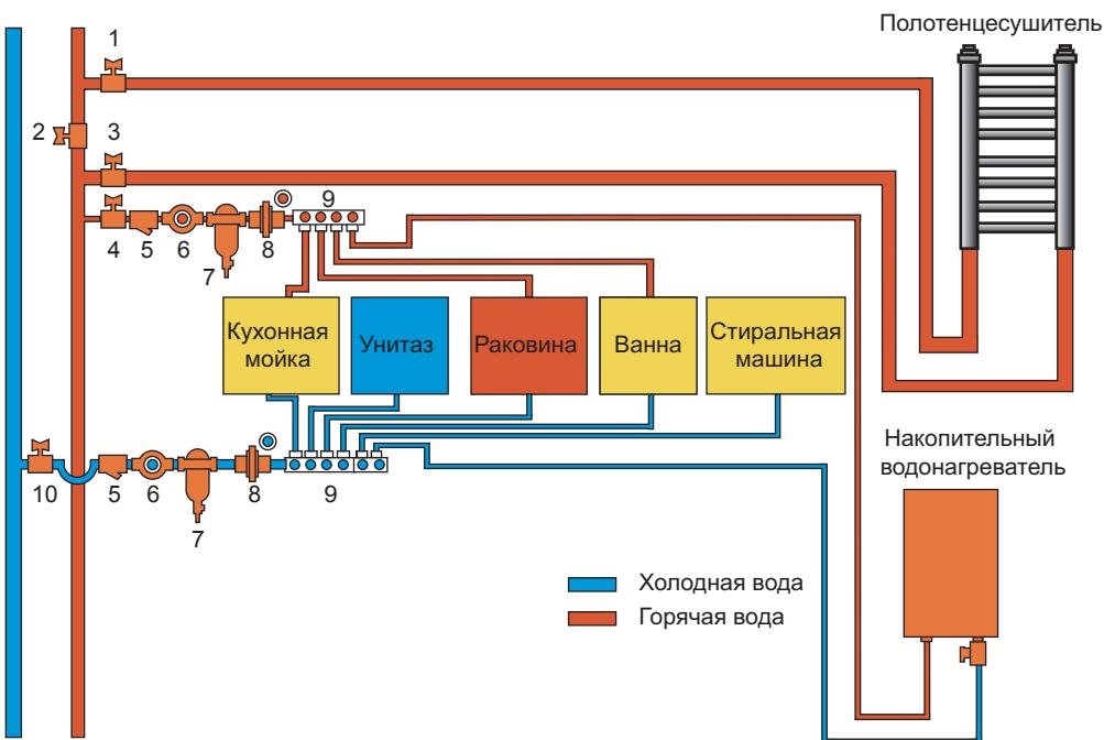
**Рис. 4.4.** Коллекторная схема разводки водопровода: 1 — верхний шаровой кран на полотенцесушитель; 2 — шаровой кран на перемычке трубы; 3 — нижний шаровой кран на полотенцесушитель; 4 — основной (аварийный) шаровой кран на горячую воду; 5 — фильтр грубой очистки; 6 — счетчик; 7 — фильтр тонкой очистки с сеткой 100 мкм; 8 — редуктор давления; 9 — коллектор; 10 — основной (аварийный) шаровой кран на холодную воду
