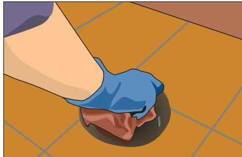
**Рис. 10.87.** Затыкаем канализационное отверстие тряпичным кляпом
